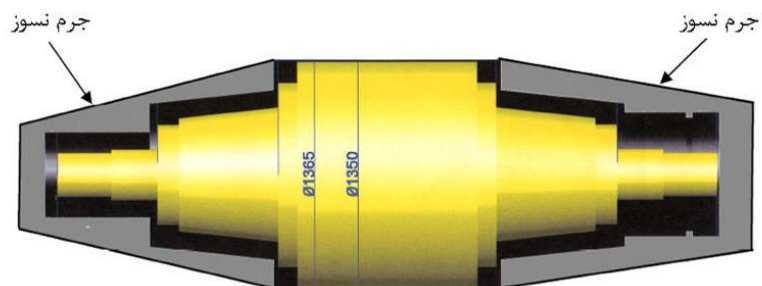
شکل ۹- نمایی از غلتک پشتیبان نورد تاندم که قسمتهای گردن و شافت توسط جرم نسوز پوشش داده شده است
