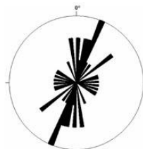
شکل ۱۱. نمودار های گل سرخی از پراکندگی درزه ها، شکستگی ها و گسل های منطقه مورد مطالعه. همانطوری که در نمودار های مشخص می باشد پراکندگی متنوع سیستم های شکستگی و درزه های موجود در منطقه باعث کاهش کیفیت سنگ، پر شدگی و در نهایت خرد شدگی سنگ شده است.
