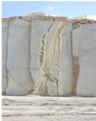
شکل ۸. نشانه های بارز کششی در محدوده شرقی مجموعه معادن، به صورت اختلاط لایه های مقاوم و نامقاوم و توسعه بودینهای کششی به عنوان نشانه ای از فاز تکتونیک جدید و موثر در تخریب سینه کار و توقف کار.
