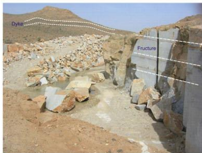
شکل ۷. آثار زون برشی با شکستگی های کششی رها شوند و ادامه آن در کوههای مشاهده شده (معدن علی کریمی) در تصویر. دید عکس به سمت شرق
