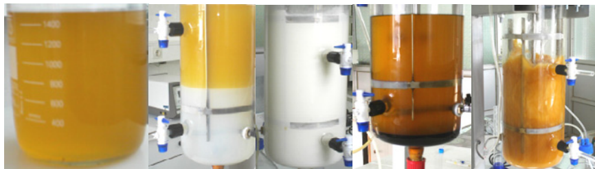
شکل (۲)- مراحل استحصال (از راست به چپ: انجام واکنش ترانس استریفیکاسیون- ته نشین شدن گلیسرین- آبشویی- ته نشین شدن آب پس آبشویی- بیودیزل به دست آمده قبل از شفاف سازی)
