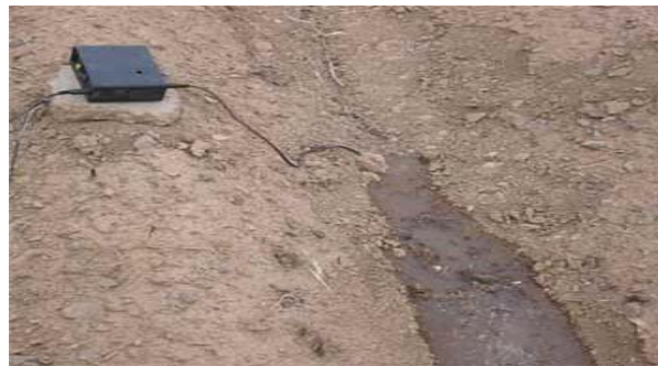
شکل شماره ۲) دستگاه اتوماتیک ثبت پیشروی آب
